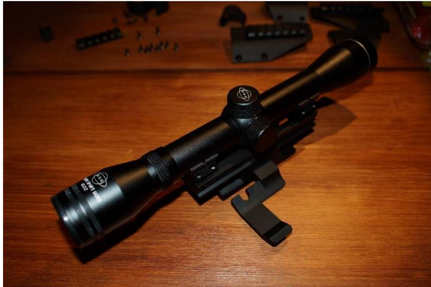
Im nächsten Schritt wird die ober Hälfte der Ringe aufgesetzt, danach folgt das Oberteil des Montagebocks. Nun werden auf jeder Seite die Innensechskantschrauben wieder eingeschraubt.
