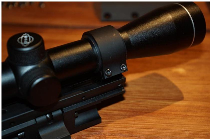
Noch nicht fest anziehen, da das Zielfernrohr noch in der Achse ausgerichtet werden muss!!!
