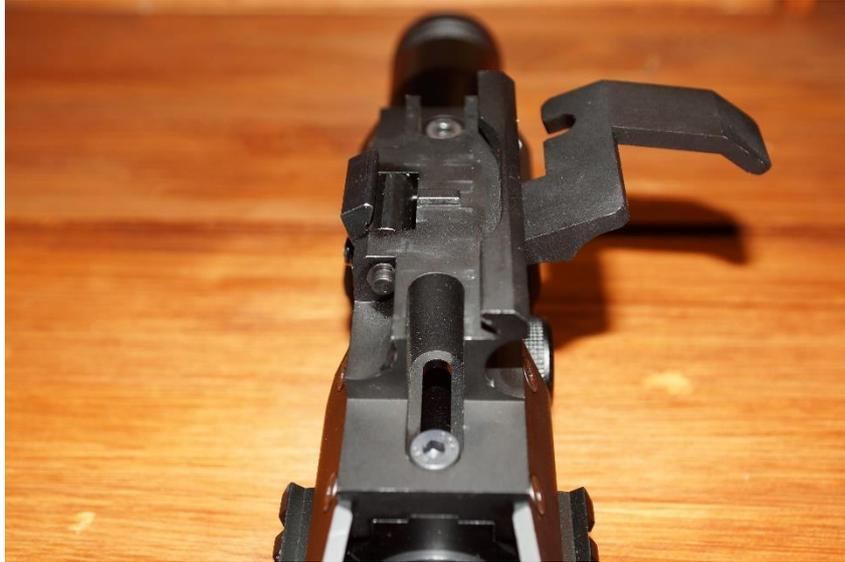
Das innere der Montage wie zum Beispiel der Exzenter, die Feder, der Führungsbolzen der Feder, Lagerbolzen und Schrauben sind aus Stahl und von guter Qualität.
