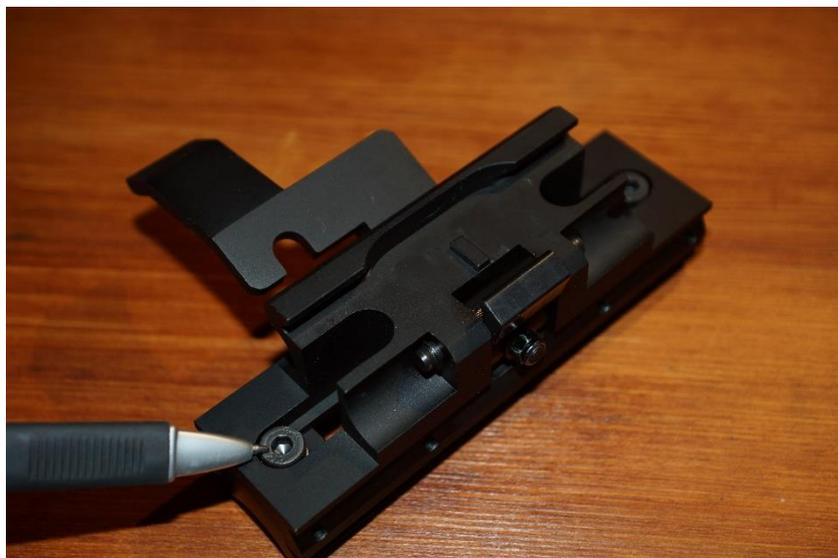
Anschließend habe ich in meinem Fall die Reduzierringe auf 25 mm verwendet. Diese werden nun in die Montageböcke eingelegt. Anschließend setzt man das Zielfernrohr auf den Montagebock auf und drückt es etwas nach unten.
