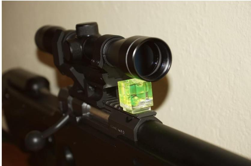
Anschließend können die Schrauben angezogen werden, dies sollte gleichmäßig und über Kreuz geschehen. Immer Stück für Stück die Schrauben anziehen, da ansonsten die komplette Optik verzogen werden kann.
