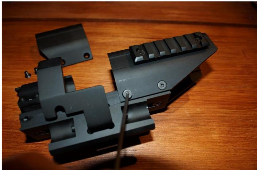
Als zweiter Schritt werden jeweils die vier Schrauben der Montageringe herausgedreht. Danach lässt sich die obere Hälfte abnehmen.
