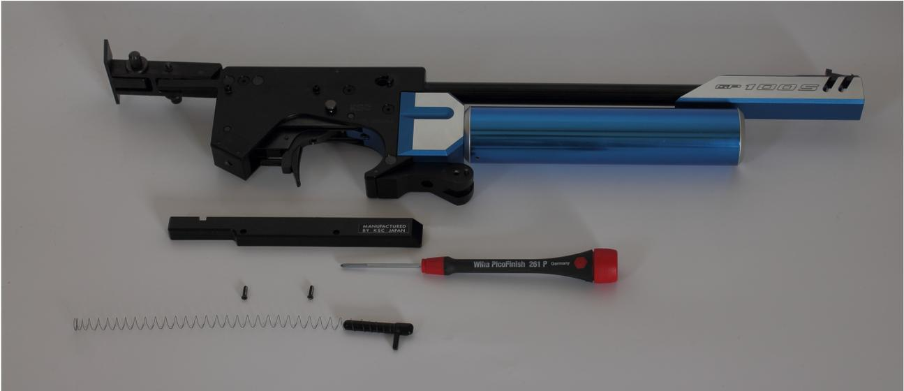
Anschließend schiebt man die Feder komplett über die längere Seite des Hebels und hält diese mit der Hand fest. Nun wird der Hebel durch das Loch hinten am Magazin geführt und seitlich eingerastet. Das hält von allein wunderbar, trotzdem sollte man, wenn man nun das Magazin wieder am Gehäuse ansetzt, sehr vorsichtig sein, damit sich der Hebel nicht löst, sonst schießt dieser quer durch den Raum. Ist das Magazin wieder angeschraubt, prüft man die Funktion und weiter geht's.
