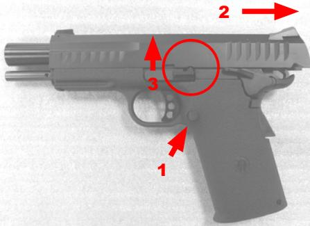
首先取出彈匣，將滑套往後拉至如圖示的位置，對正滑套上的缺口並將滑套止動銷取出。
