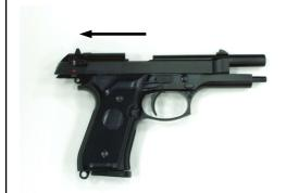
PULL THE SLIDE COMPLETELY TO THE REAR.
