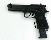
PRESS MAGAZINE CATCH AND REMOVE MAGAZINE. 2.REMOVE THE SLIDE
