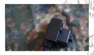
An der Rückseite befindet sich die Halteklammer der PTT.
