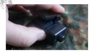
An der Unter Seite entdeckt man das Kabel der PTT diese ist am Ende mit einer Klinke Anschluss für Funkgeräte versehen.
