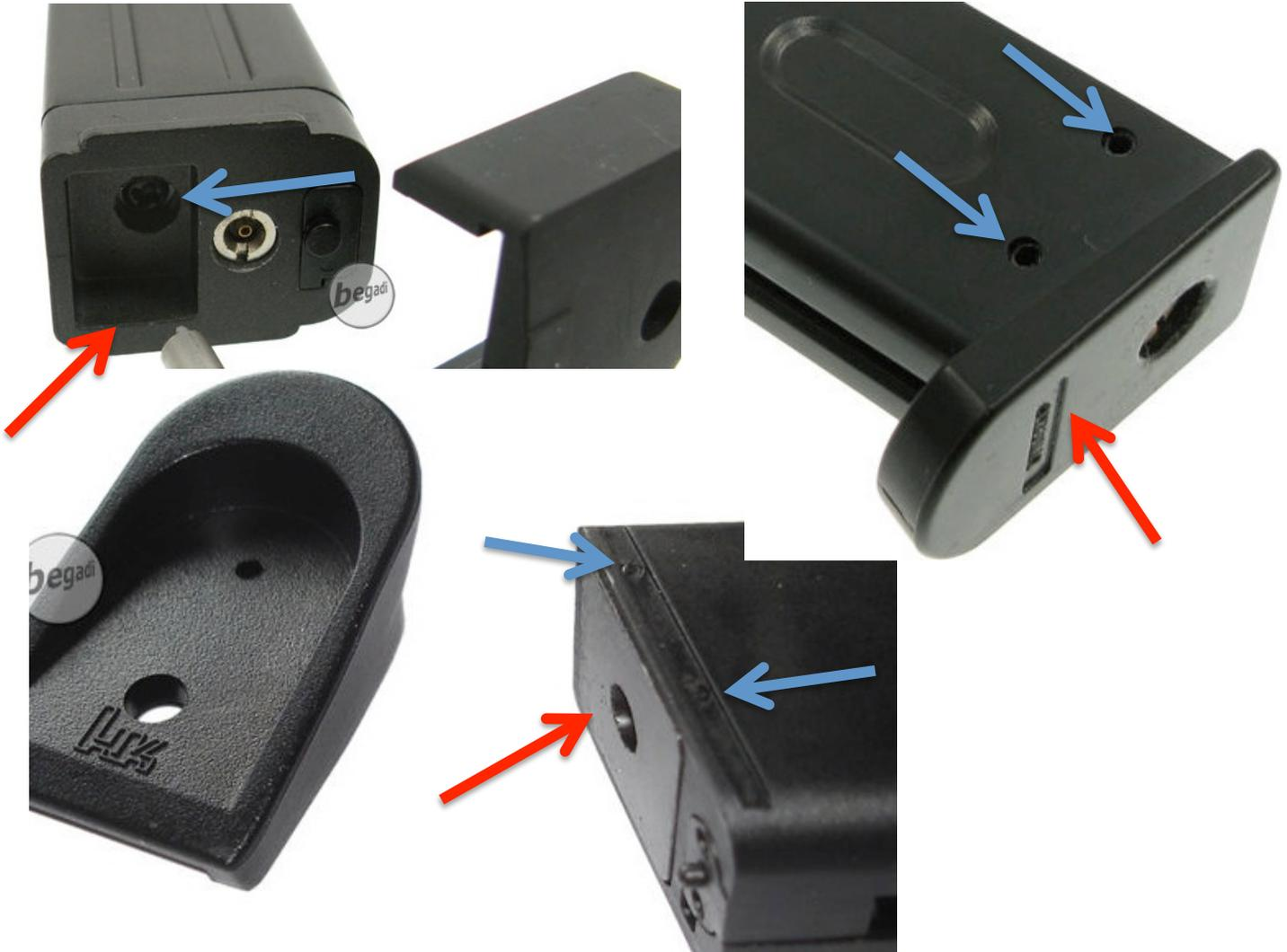
4. Diese Pins/Schraube entfernen und den Magazinboden rausnehmen. Zwischen Magazinboden und Magazin befindet sich ein Dichtungsring (roter Pfeil). Die Auskerbung für den Dichtungsring am Magazinboden (blauer Pfeil) und den Ring selbst mit Silikonfett einschmieren.
