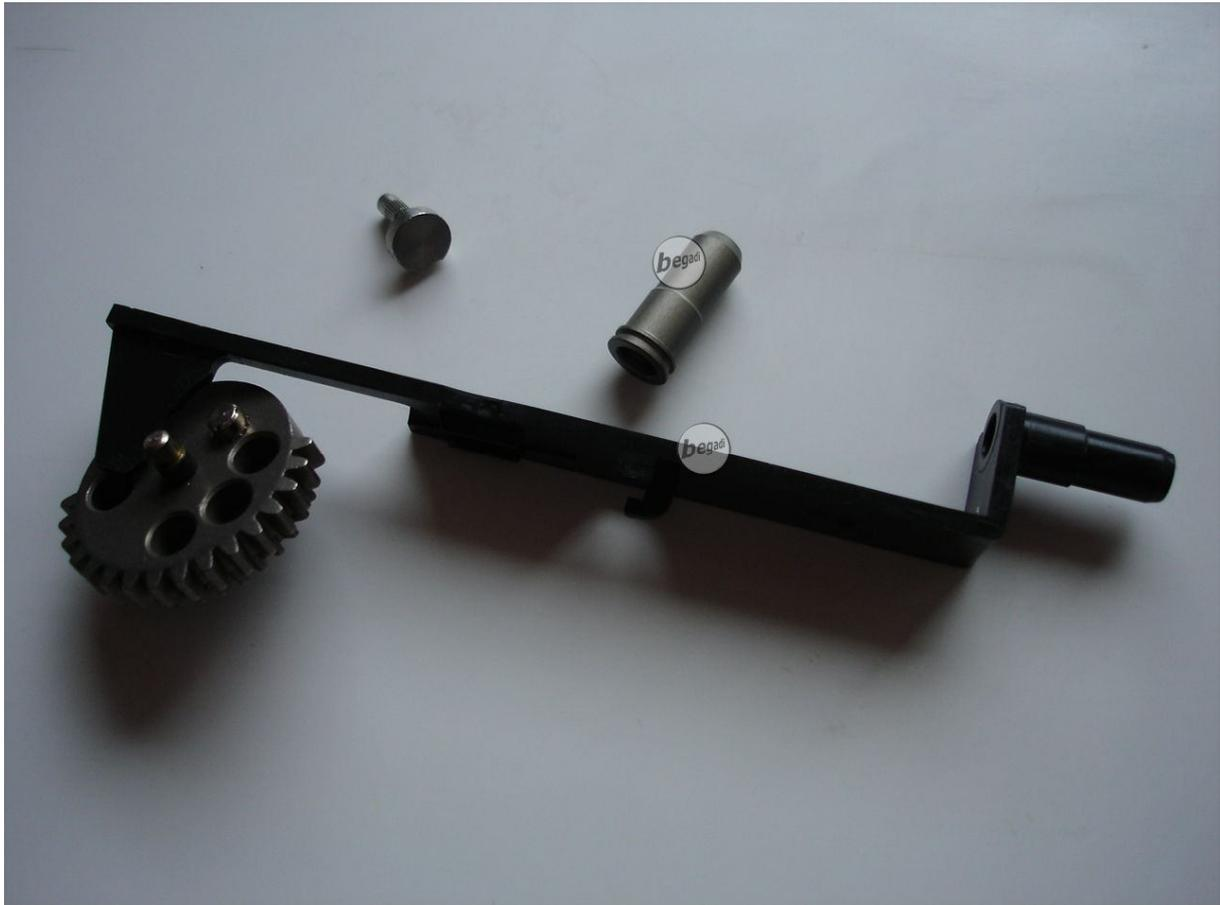
Die „Tappet Plate“ ist ein aus Plastik geschnittener Zugmechanismus, der mit dem „Nozzle“ verbunden ist.
