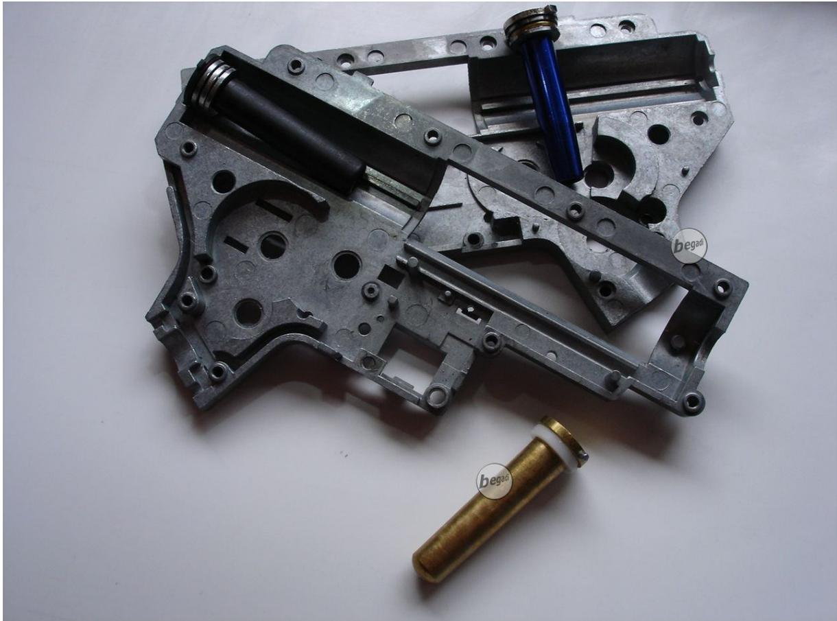
Die „Gearbox-Shell“ bildet das Gerüst der „Gearbox“.
