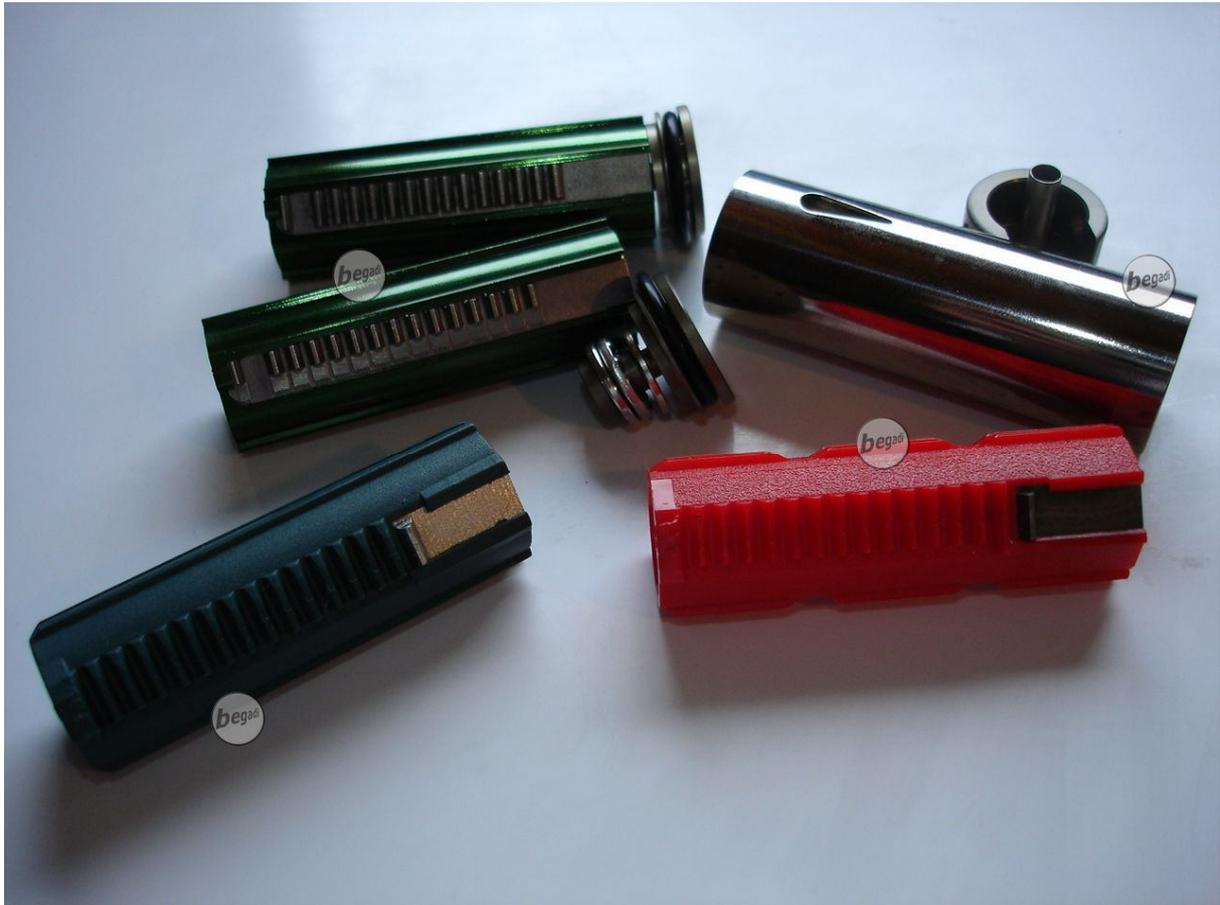
Der „Piston“ liegt verzahnt mit dem „Sector Gear“ im oberen Bereich der „Gearbox“. In ihm liegt die Feder entweder fest montiert oder lose. Am vorderen Ende sitzt der „Piston-Head“; Gut zu erkennen anhand des großen O-Ringes aus Gummi.
