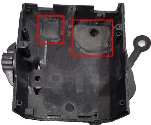
Die markierten Bereiche wurden leicht geschliffen, die Schrauben plan geschliffen.
