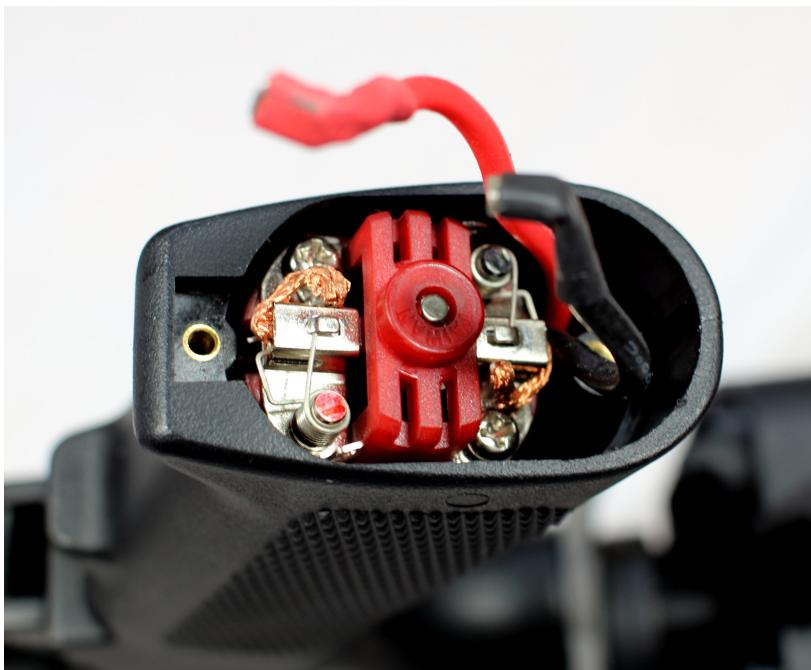
Entfernen Sie die Abdeckung, danach entfernen Sie die beiden Kabel vom Motor, diese sind nur aufgesteckt.
