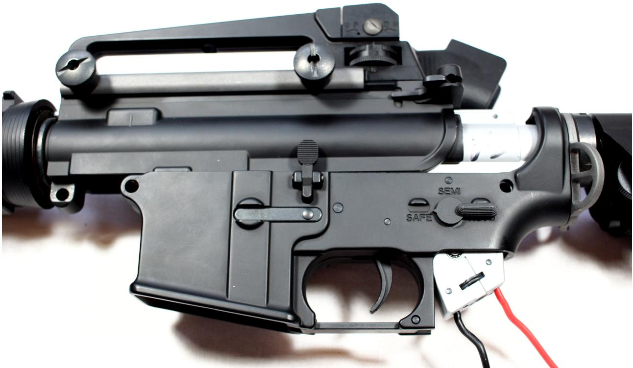
**Ziehen Sie nun den Upper vom Lower Receiver, in dem Sie diesen vorsichtig nach vorne schieben. ACHTUNG die HopUp Unit bleibt dabei möglicherweise an der Gearbox hängen und wird mit herausgezogen. Diese können Sie durch vorsichtiges ziehen voneinander trennen, sie sind nur zusammengesteckt.**
