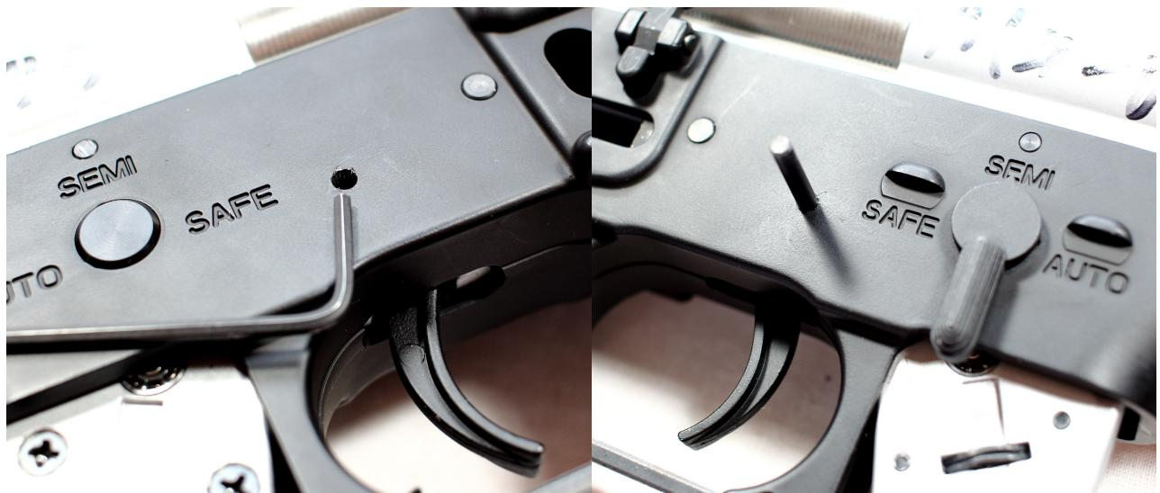
Als nächstes müssen Sie noch den Pin oberhalb des Abzugs entfernen, wenn Sie keinen passenden Austreiber besitzen, den ich an dieser Stelle empfehle um ein verkratzen des Gehäuses zu vermeiden, können Sie auch den Sechskantschlüssel verwenden. Ziehen Sie den Pin von Hand so weit wie möglich heraus, dieser ist nicht gesichert, muss aber nicht komplett ausgeschlagen werden.
