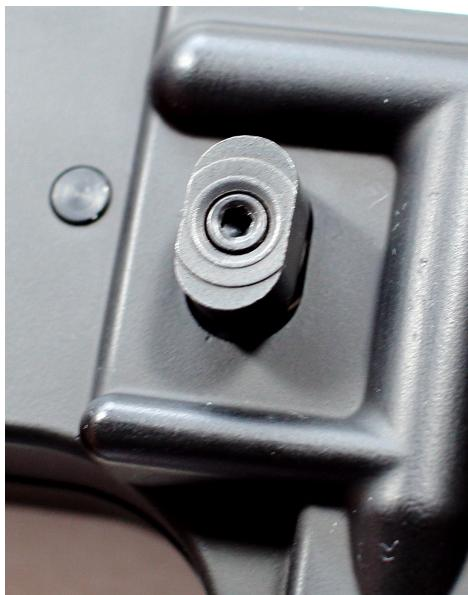
**Entfernen Sie nun mit einem Sechskantschlüssel Größe 2 den Mag Release Button. Sie erhalten die 4 im Bild unten abgebildeten Teile.**
