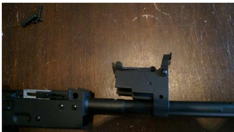
Man findet darunter eine Madenschraube, diese entfernt man nun.
