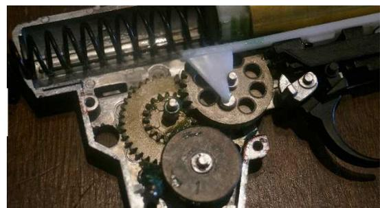
Das Piston verfügt über eine Kunststoffzahnreihe. Dabei wurde der erste Zahn aus Metall ausgeführt. Der Piston Head dichtet sehr gut ab. Er besitzt 6 Ventilationslöcher.
