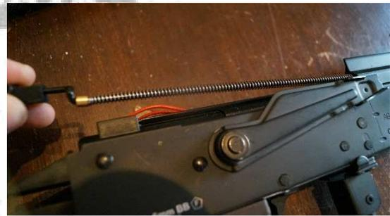
Nun entfernt man den vorderen beiden Bolzen. Nun schiebt man die hintere Visierung nach vorne.
