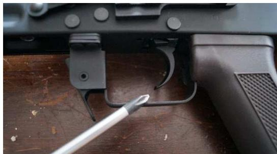
Der Trigger und Triggerrguard sind ebenfalls sehr sauber verarbeitet. Hier wurde Stahlblech und Guss verwendet.
