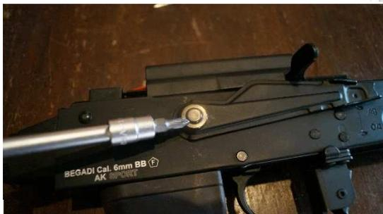
Kommen wir nun zum Ausbau der Gearbox. Als erstes entfernen wir den Feuerwahlhebel, dazu entfernt man eine schwarze Abdeckkappe. Darunter findet man eine Kreuzschlitzschraube dies entfernt man nun.
