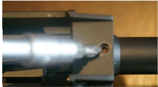
Des Weiteren entfernt man die 2 Kreuzschlitzschrauben am Hop Up. Jetzt können wir den Outerbarrel nach vorne abziehen. Nun können wir den Lauf mit der Hop Up Unit entfernen.
