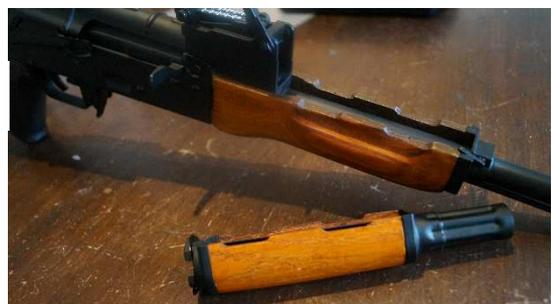
Als nächstes kommen wir zum unteren Handguard. Dazu legt man den kleinen Hebel nach vorne um und anschließend schiebt man das Metall Teil nach vorn weg. Des Weiteren entfernt man den AK Typischen Reinigung Stab. Nun kann man den unteren Handguard entfernen.
