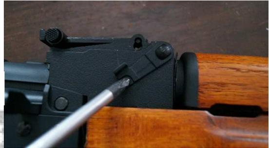
Bei genaueren untersuchen der rechten Seite findet man einen weiteren kleinen Hebel zum Entfernen des unteren Handguard, später dazu mehr.
