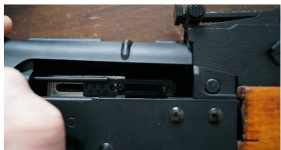
Des Weiteren findet man einen kleinen Hebel mit dem man das obere Handguard entfernen kann, später dazu mehr.
