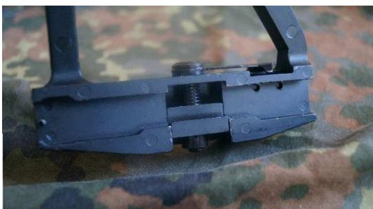
An der Innen Seite der Mount entdeckt man ein Schienen System. Dieses dient dann dazu an einen vorhandenen Side Mount Base zu befestigen.
