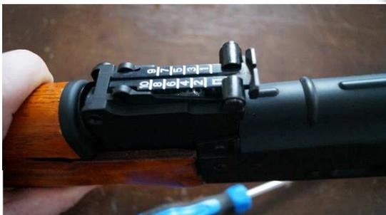
Im mittleren Teil der Waffe findet man den 2 teil der Visierung, diese lässt sich stufenweise durch drücken des Knopfes an der rechten und linken Seite in der Höhe verstellen.
