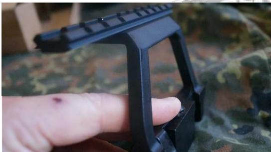
Kommen wir nun zum restlichen Gestänge der Mount. Sie ist leicht gebogen so dass sie an jeden gängigen AK Modell befestigt werden kann.
