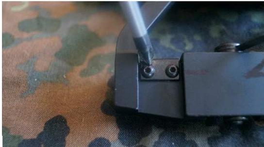
An der Außen Seite ist noch ein kleines gebogenes Metall Blättchen mit 2 Imbuss Schrauben befestigt. Dieses dient dazu dass der Hebel einrastet und im geschlossenen Zustand sich nicht einfach lösen kann.
