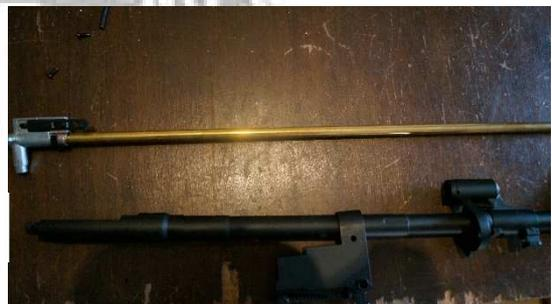
Der Lauf ist aus Messing gefertigt, er hat eine Länge von 500mm und einen Durchmesser von 6,08mm.
