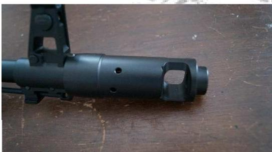
Am Vorderen Ende findet man den Mündungsdämpfer dieser ist an einem 14mm Negativgewinde befestigt. Diesen kann man demontieren in dem man den kleinen Stift am Korn nach inne schiebt.
