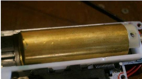
Der Cylinder ist aus Messing gefertigt. Beim Motor wurde ein Standard Motor verbaut, hierbei handelt es sich um ein Short Type.
