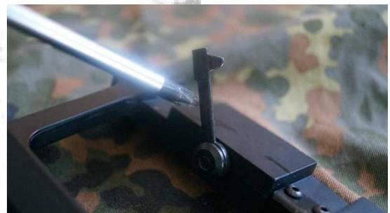
Der Hebel wird von einer Schraube mit Feder gehalten. An der Unterseite der Schraube befindet sich eine Mutter zum Einstellen der Spannkraft des Hebels.
