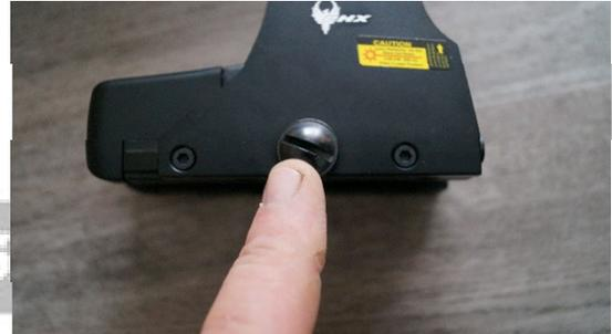
An der Frontseite findet man einen Hebel, wo man das Batteriefach öffnen kann und die mitgelieferten Batterien einsetzen kann.
