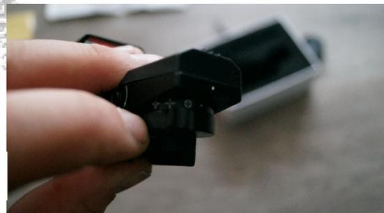
Auf der oberen Seite findet man die zweite Einstellschraube zum Einstellen des Rotpunktes und des Batteriefaches.
