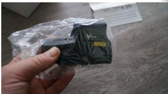
Packt man nun das Red Dot aus, fällt als erstes die Standard Größe von einer Länge 107mm und der Höhe von 61mm auf. Des Weiteren hat ein Gewicht von 220g. Gefertigt wird es aus Metall und Kunststoff. Der erste Eindruck wirkt sehr wertig, es sind kaum bis gar keine Grate zu finden. Das Red Dot ist in einem Mattschwarz gehalten.
