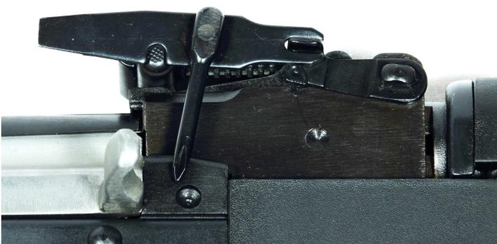
Ebenfalls am Visierblock befindet sich der Hebel, mit welchem man den oberen Handschutz entfernen kann, bewegen lässt sich dieser sehr schwer, dafür benutzt man am besten entweder den Ausschnitt an dem kleinen Multitool im Schaft oder den kleinen Schraubenschlüssel aus der Verpackung.
