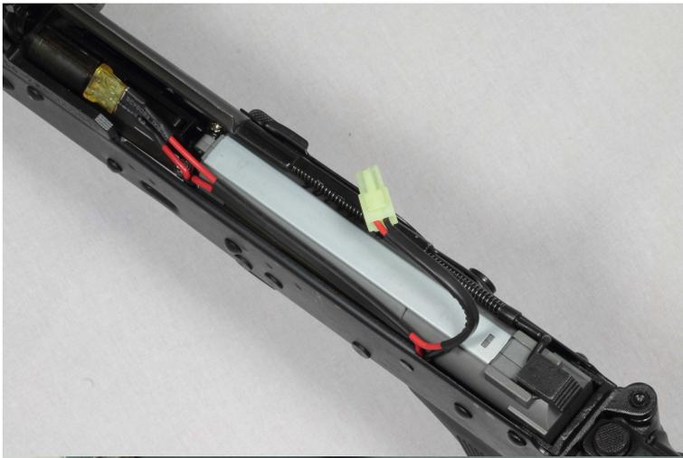
Unter dem Gehäusedeckel findet sich der Platz für den Akku, dieser ist leider sehr begrenzt, so dass nur sehr kleine Akkus verwendet werden können. Ein LiFe 9,9V Stick Type passt mit Ach und Krach. Der Verschluss ist leider nicht so massiv gebaut wie z.B. bei der ICS AK, dies wäre das Tüpfelchen auf dem I im Bezug auf den Realismus, allerdings muss natürlich auch irgendwo der Akku hin und da gibt es hier nur diese eine Möglichkeit. Es ist, wie inzwischen gang und gebe bei
