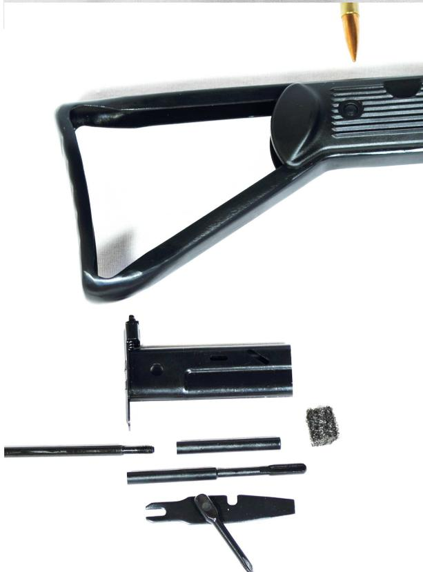
verfügt, mit welcher man den Hebel zum entfernen des oberen Handschutzes entriegeln und das Korn in der Höhe verstellen kann. Dabei ist außerdem noch ein kleines Stück Schaumstoff, welches dafür sorgt, dass die Teile in der Schublade nicht klappern. Man braucht bei dieser Waffe für fast alles ein entsprechendes Werkzeug, ganz wie bei einer echten Waffe, das ist von RS so beabsichtigt und wird in der Anleitung wie folgt beschrieben „... make players feel like acting as a soldier“.
