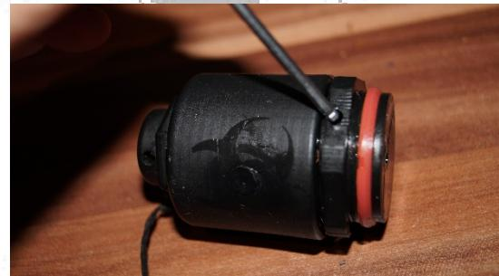
Mit Hilfe eines Inbusschlüssel/Schraubendreher kann man nun gegen die Uhrzeigerrichtung die Granate aufdrehen und kann somit denn oberen Teil zerlegen.
