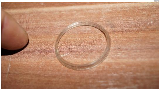
Im inneren des oberen Körperteils findet man nun eine weiter Dichtung. Diese sollte man regelmäßig mit Silicon spray oder Silicon fett warten.
