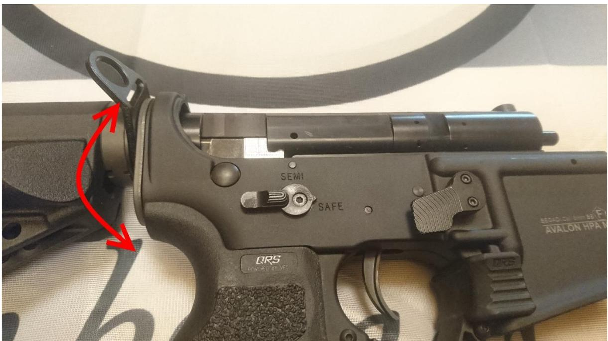
Abbildung 5: Die Slingplatte ist um 360° drehbar
