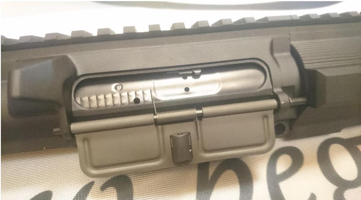
Abbildung 7: Fake-Bolt aus Aluminium
