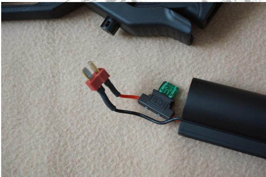
Die ICS 262 ist Rear Wired. Das bedeutet, dass die Anschlusskabel für den Akku im Stocktube untergebracht sind. Dieses wird nach dem Abziehen des Stocks sichtbar.
