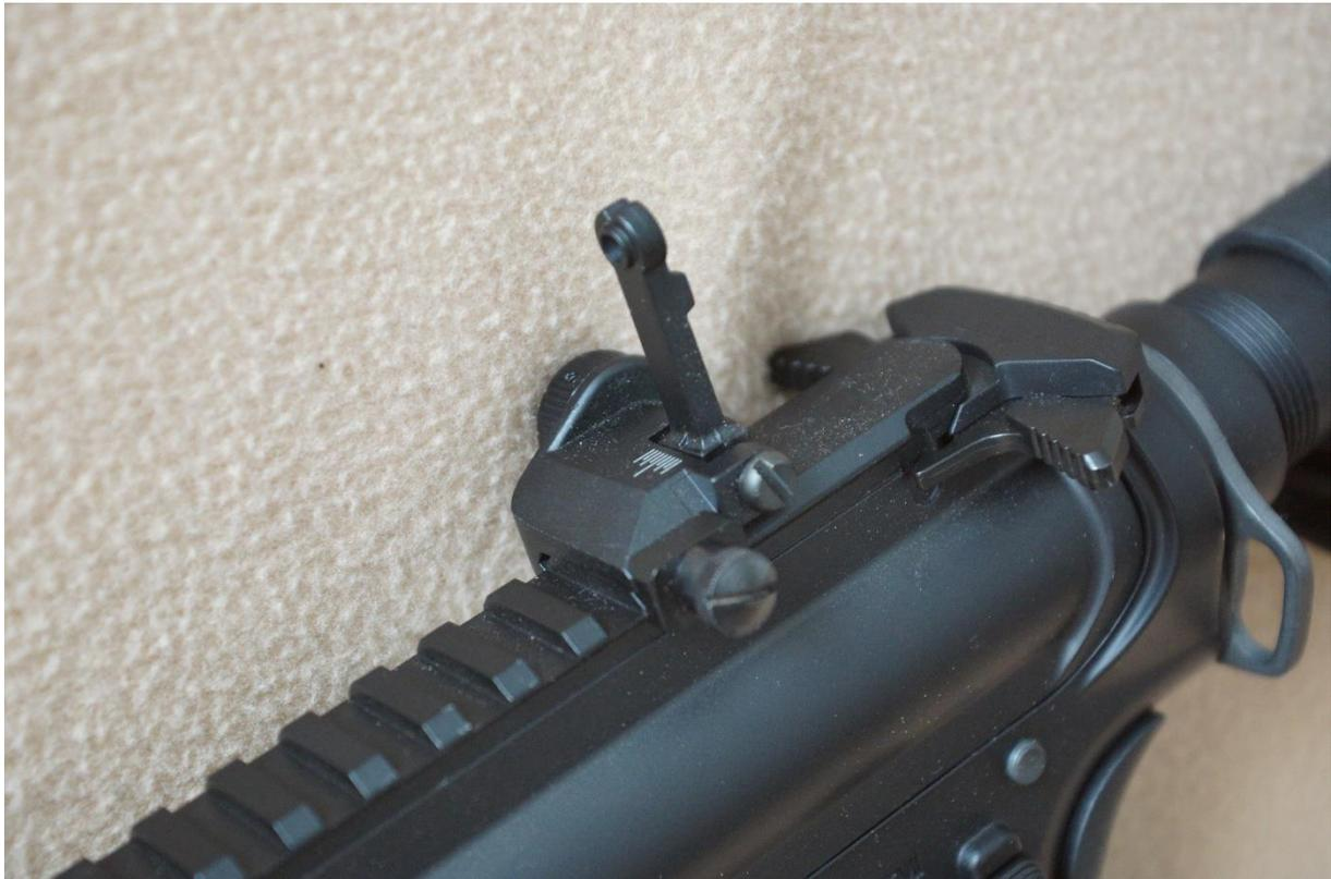
Das vordere Visier ist mit einem kleinen Druckknopf ausgestattet. Dieser gibt nach dem betätigen das Visier frei. Die Visiere lassen sich sehr gut einstellen. Das Vordere in der Höhe, und das Hintere nach links und rechts.
