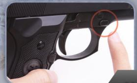
TURN THE SLIDE RELEASE LEVER TO RELEASE MODE.
