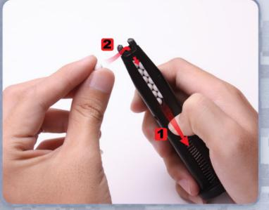
1 PULL THE MAGAZINE FEED SPRING DOWN AND HOLD.
