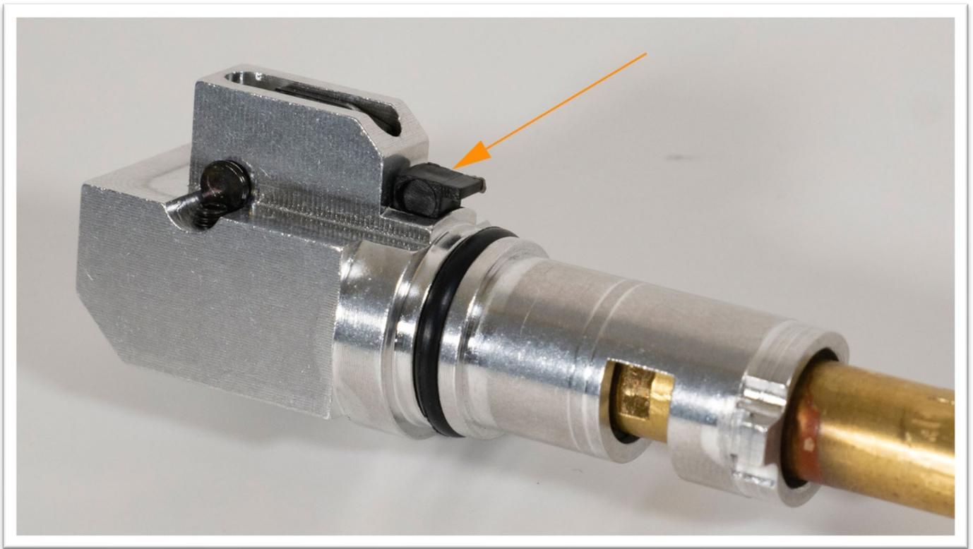
**8:** Schieben Sie nun das Einstellrad von vorne über den Lauf und auf die HopUp Unit. Sichern Sie anschließend Lauf und Einstellrad mit dem beiliegendem C-Clip.
