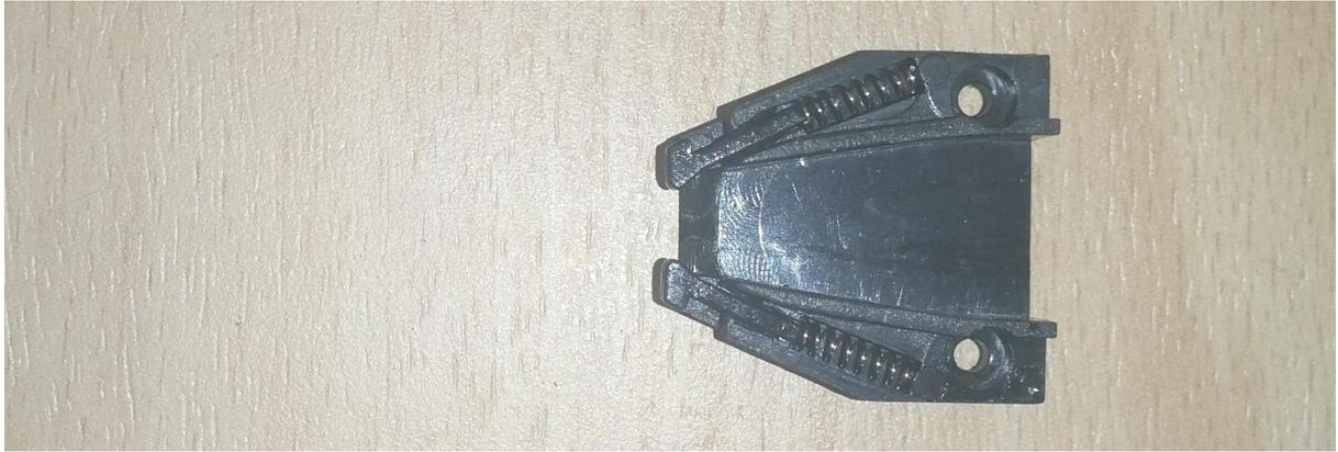
Nun müssen die Federn leicht in die Länge gezogen werden, damit diese ein wenig mehr Druck auf die Bügel ausüben.
