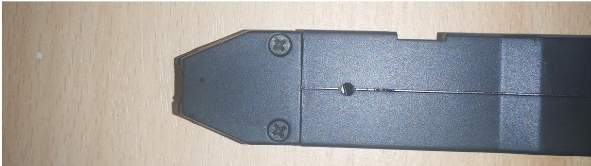
Um die Magazinfeder im Inneren zu behalten, kann man diese mit dem Schraubendreher reindrücken und eine der beiden Schrauben in das Loch fallen lassen.
