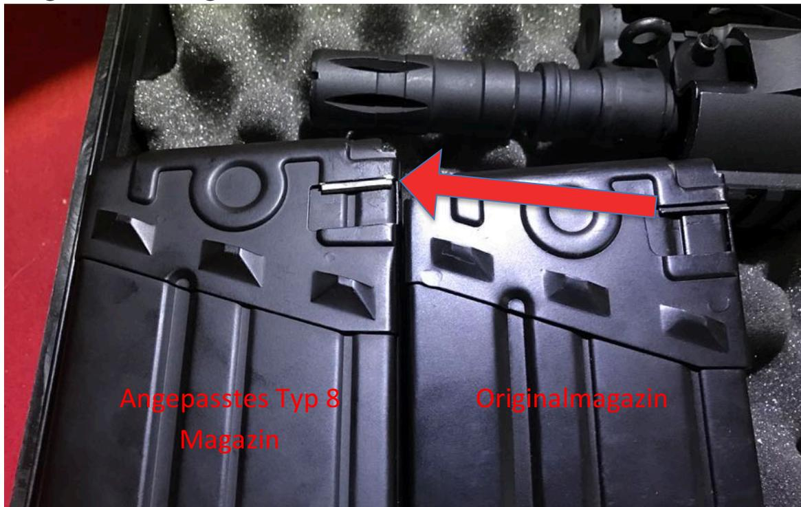
Um das Problem zu beheben, muss ein kleines Stück Blech/Plastik (zB von einer alten Magazinhülle, PC Gehäuse, Aufbewahrungsbox, CD, etc) in das Magazin geklemmt werden. Dieses hat zur Folge, dass das Magazin weiter in die Waffe gedrückt wird und dadurch problemlos feedet.
