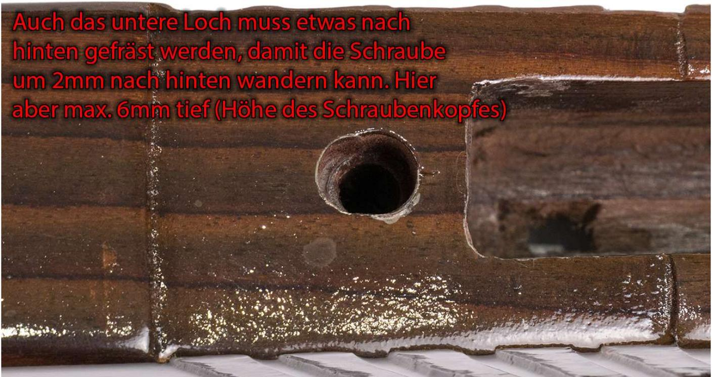
Um zu gewährleisten, dass unsere Schraube auch gerade nach oben kann, bohren oder fräsen wir nun das komplette Loch im Inneren durch. Hier kann **ein 6mm Holzbohrer** genommen werden, aber auch unser kleiner **Fräskopf** leistet hier seinen Dienst. Zu beachten ist, dass man hier **nicht die volle Länge** des Langlochs durchbohrt, da unser Schraubenkopf später an der unteren Kante aufliegen muss und nicht durch das Loch fällt.
