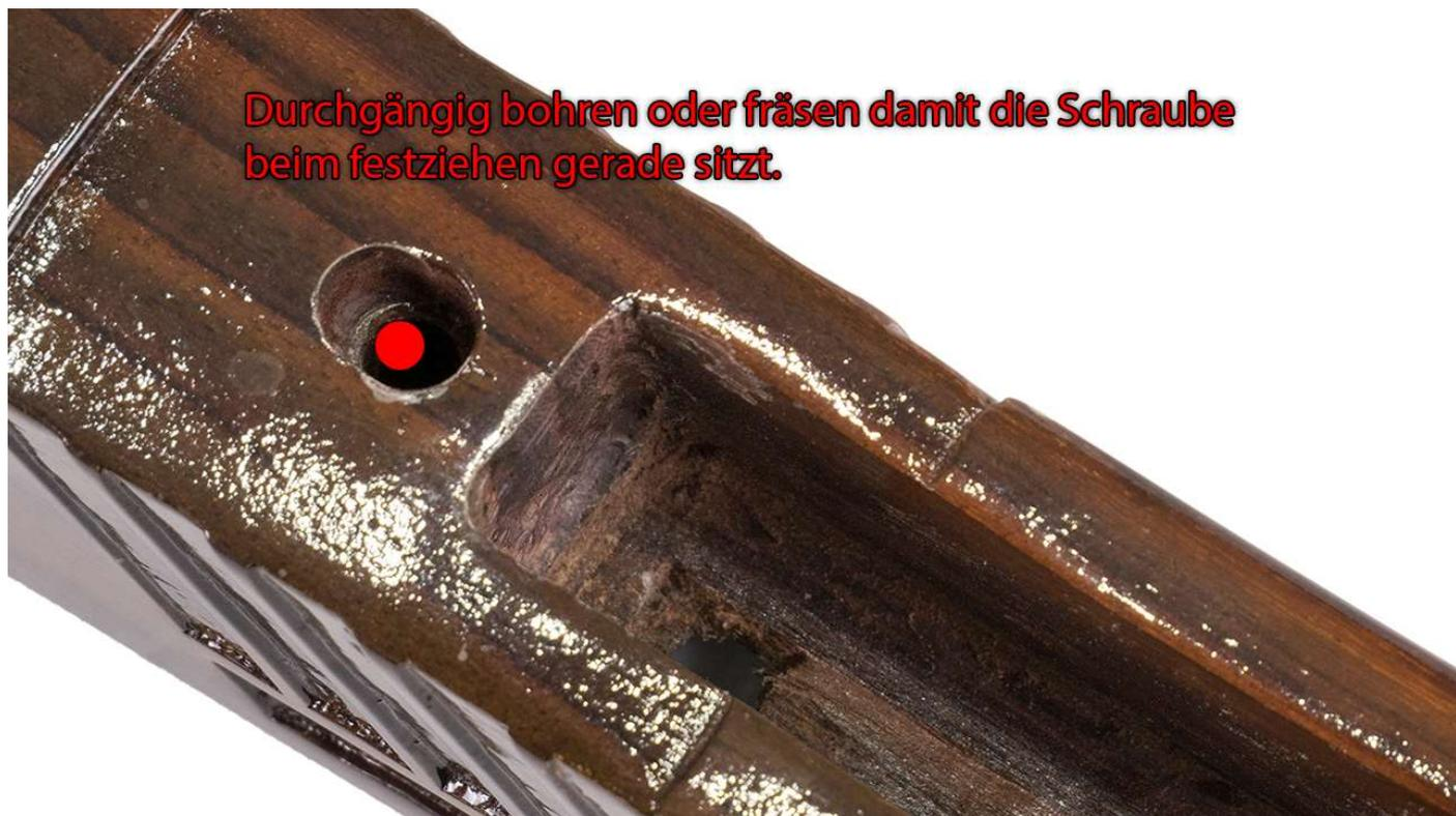
**Durchgängig bohren oder fräsen damit die Schraube beim festziehen gerade sitzt.**
