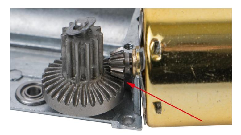
**4:** Prüfen Sie den Durchmesser der Aufnahme, diese beträgt 6,5mm. Bei TM AEP Modellen passt diese zum Motorkäfig, bei Cyma Modellen muss diese etwas nachbearbeitet werden damit der Motor ordentlich passt und auch eingestellt werden kann.
