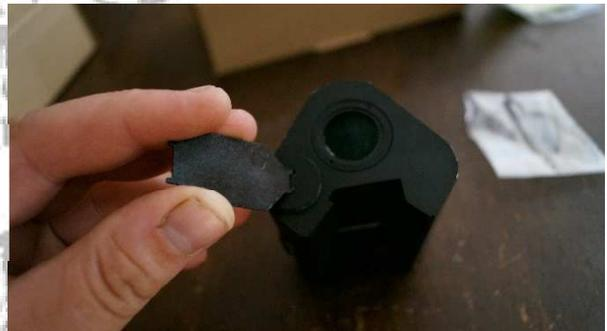
Die Batterie wird im Fach mithilfe einer Feder auf Spannung gehalten, bei der benötigten Batterie handelt es sich um eine CR1620 die ebenfalls mitgeliefert wird.
