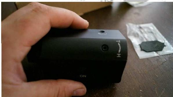
Auf der oberen Seite des Red Dot findet man eine kleine Impusschraube, diese dient zur Höhenverstellung.
