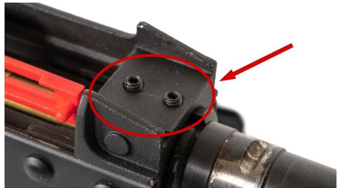
Haben Sie die Markierten Schrauben gelöst, kann der Outer Barrel nach vorne aus dem Gehäuse herausgezogen werden.
