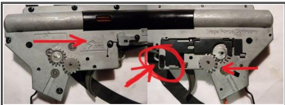
Auf der anderen Seite (linke Seite, rechtes Bild) seht ihr im Kreis, das Bauteil, dass für die mechanische Sicherung verantwortlich ist. Es muss durch die Selectorplate (das komplizierte schwarze Blechteil) in dieser Stellung gehalten werden. Die Aussparung auf dem oberen Zahnrad muss wiederum parallel zum roten Strich ausgerichtet sein, den Rest kann man denke ich ganz gut erkennen.
