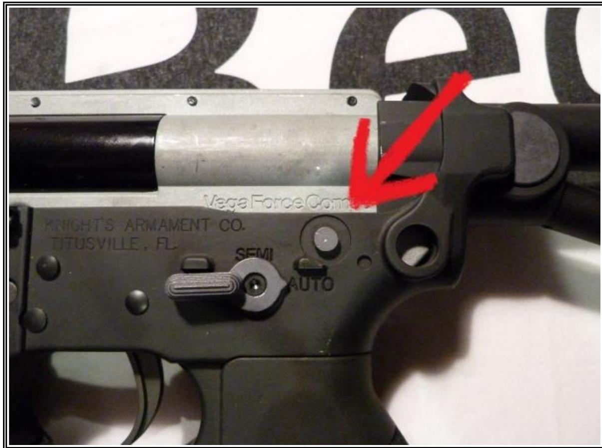
2. Mit einem dünnen Schraubendreher den Pin vom Boltcatch herausdrücken, den Body drehen und an der auf dem Bild (rechts unten) gezeigten Stelle das Bauteil herunterdrücken – der Boltcatch sollte sich auf der anderen Seite herausnehmen lassen.
