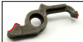
Abb. 4 – Fall sich der Cut-Off nicht weit genug absenkt ist ein Abschleifen der rot markierten Fläche erforderlich
